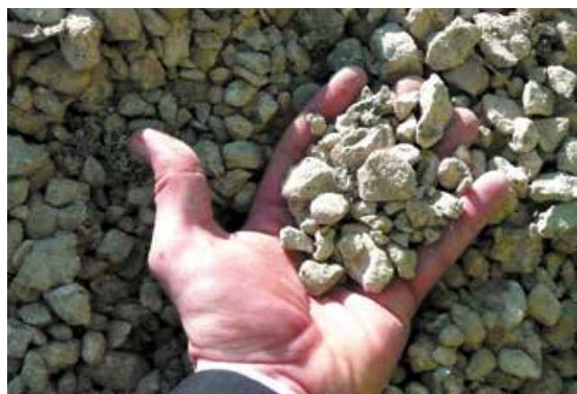
Les granulats issus de la déconstruction sont contrôlés en laboratoire avant réutilisation.
