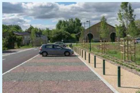
Stationnement minéral avec des dalles alvéolaires béton et d'un remplissage minéral (au dessus) ;
