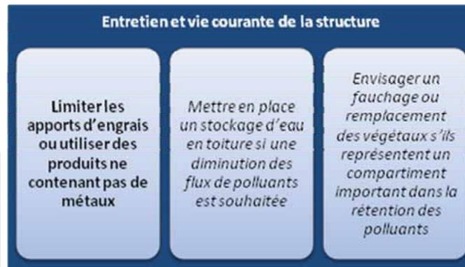
**Figure 87- Synthèse des préconisations techniques pour une diminution des flux d'ETM en sortie de toiture végétalisée**
